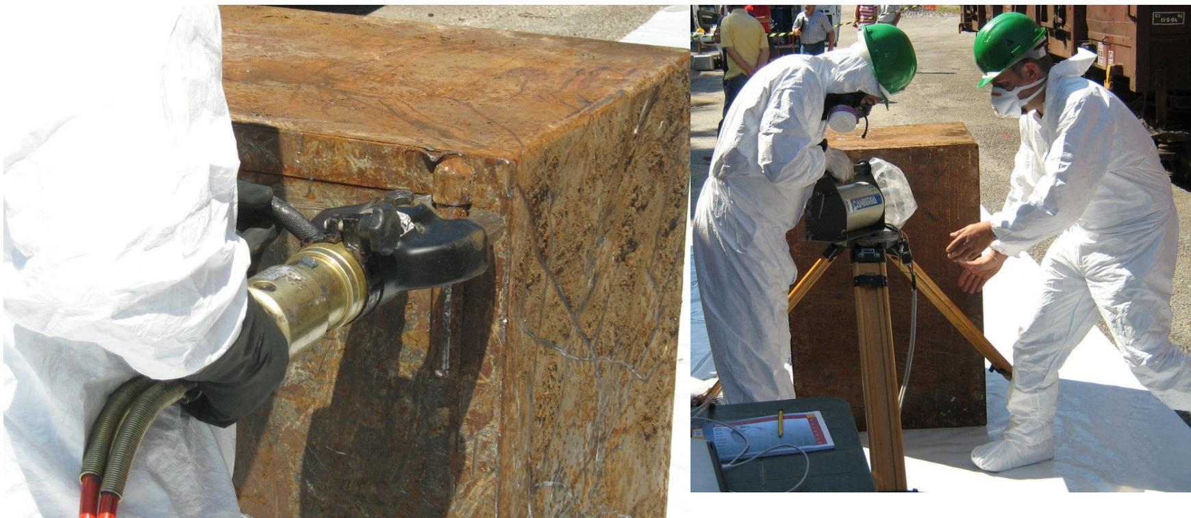
Caratterizzazione cassaforte con analizzatore multicanale HPGe portatile (ARPA FVG)
